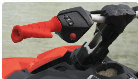
VTS™ de Curso Estendido™ (Sistema de Trim Variável) Oferece o dobro de ajustes de um VTS™ convencional, facilitando a execução de manobras elaboradas.
